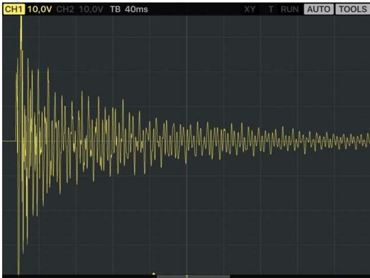
Schwingungsbild eines angeschlagenen Tamburins
